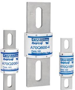
Les fusibles ultra rapides Amp-Trap® A70Q ont été développés pour les applications d'onduleurs nécessitant un  $I^2t$  extrêmement bas. Les fusibles A70Q offrent la protection la plus réactive pour les applications qui n'ont pas besoin de résister à de fortes surcharges. Généralement utilisé pour le remplacement.
