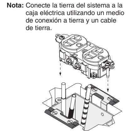
**Nota:** Conecte la tierra del sistema a la caja eléctrica utilizando un medio de conexión a tierra y un cable de tierra.
