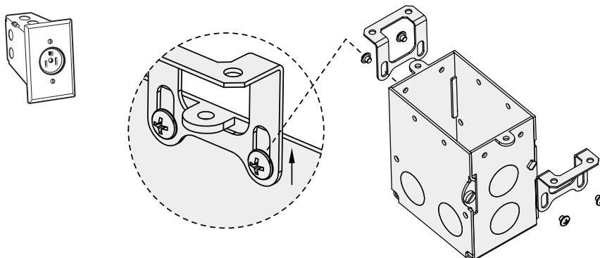
**RECEPTÁCULO DOBLE:** Monte los soportes en los **LADOS** de la caja del piso **ABAJO**.
